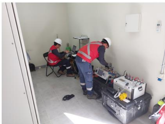
Figura N°15: Lavado de aisladores SSEE-RH y verificación de exactitud del medidor.
